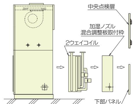
正面の下部パネル、中央点検扉、補強枠などを外し、加湿ノズルと混合調整板を取付けている枠のビスを外し、機外へ取出します。
