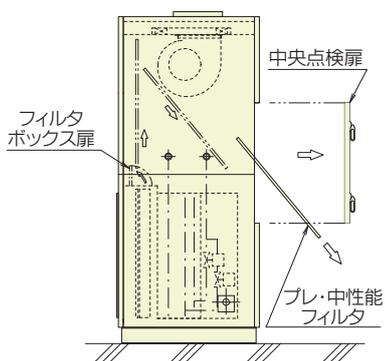
正面の中央点検扉を開き、フィルタボックスの扉を開けてフィルタを上部に引抜き、機外へ取出します。
