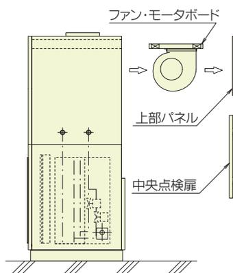
正面の上部パネル、中央点検扉、補強枠などを外し、ファン・モータボードと防振材を止めている4本のボルトナットを外し、機外へ引出します。
