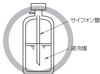
【サイフォン管付きポンベの場合】 立てたまま液冷媒を充てんできる
