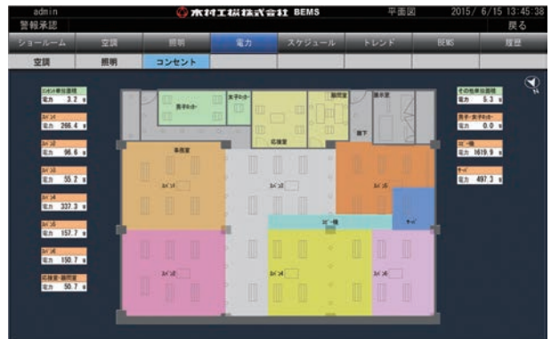
【コンセント消費電力】
