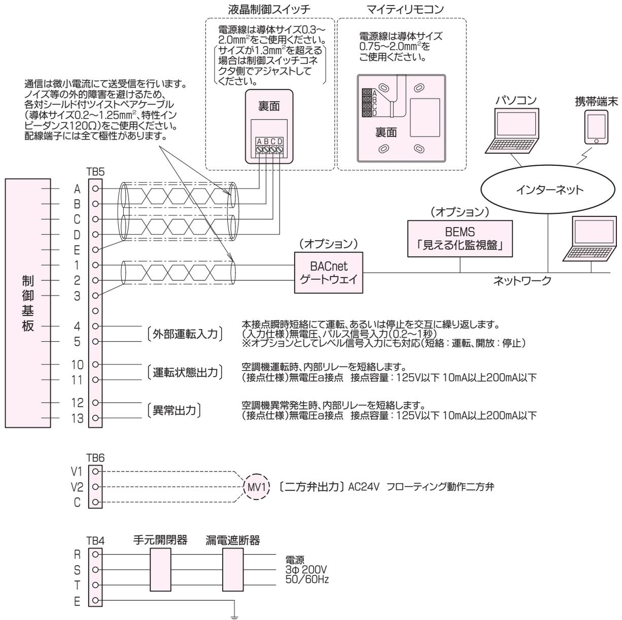
※ 電源線はファン用モータ容量に合った線径、漏電遮断器、手元開閉器を取付けてください。
