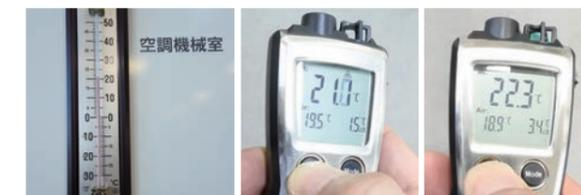
空調機械室入口前 21℃ 室中央壁面温度 21.1℃ 室中央床面温度 22.3℃
