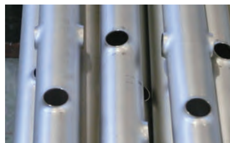
部材のバーリング加工
