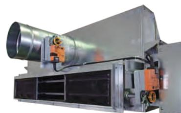
CO<sub>2</sub>制御盤で外気導入量を調整、外気ダンパ(上部)、還気ダンパ(下部)とムラの無い中段式混合で外還気等換制御し、省エネを図ります。
