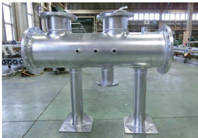
母材加工による継手レス化
