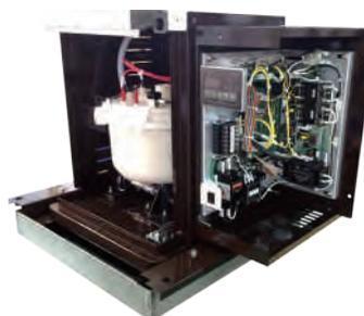
加湿器本体は天井内設置構造で、スイッチ切替音や水切り音の無い低騒音設計、導電制御で加湿量を安定供給します。
