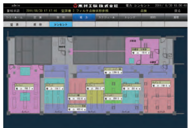
【コンセント消費電力】
