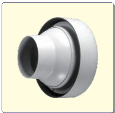
結露防止リングからパンカールーバーの周囲にダクト内の空気を僅かに吹き出し、結露を防ぎます。
