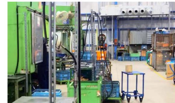
熱を発生する大型の機械が通路沿いに4台並ぶエリアには、壁側に1台 (CRV2-6900HPSE) 設置。到達距離15m超のドライエアーが充分に行き届きます。
