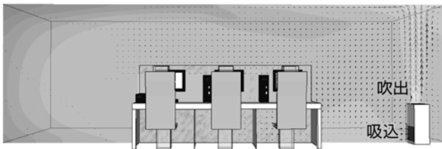
図5-2 床置き空気清浄機による清浄の様子 (壁面付近に設置したケース)
