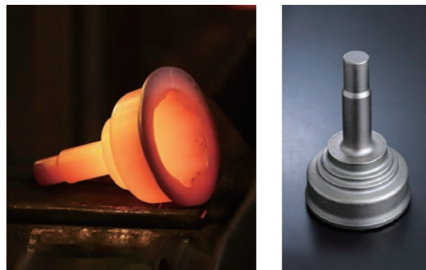
年間約900万个製造されている等速ボールジョイント
