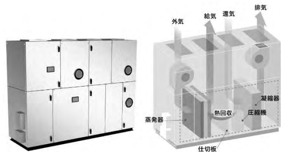
図1 空冷ヒートポンプ式熱回収外調機（従来品）
