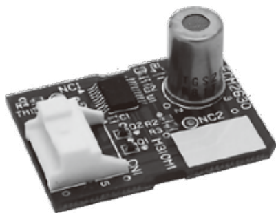
写真2 R32 漏洩検知センサ 4)
