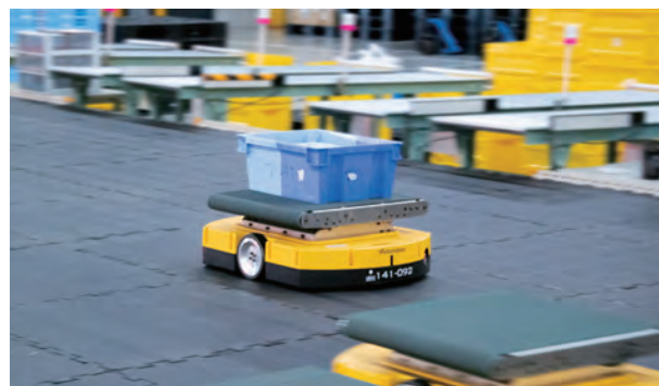
入荷時の仕分け作業で活躍する無人搬送車（AGV）
