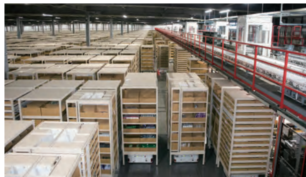
無人搬送車（AGV）が専用棚を持ち上げて運ぶ在庫エリア
