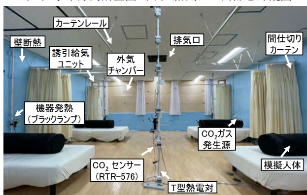
図2 4床病室実大実験室の写真
