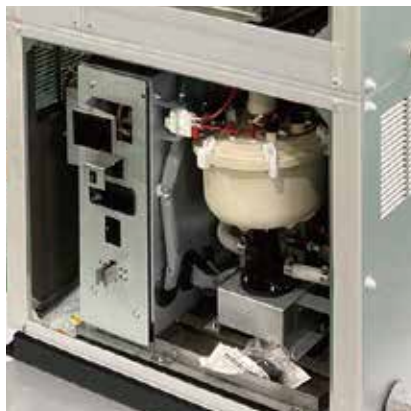
外気取入れ、蒸気加湿器を標準組込 (外気冷房、加湿暖房可、省エネ性大)
